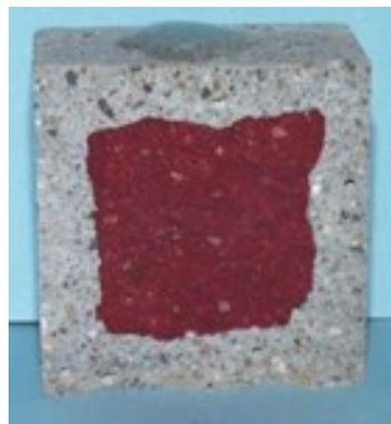
Bild: Hydrophobierungen und das Eindringvermögen in den Untergrund
