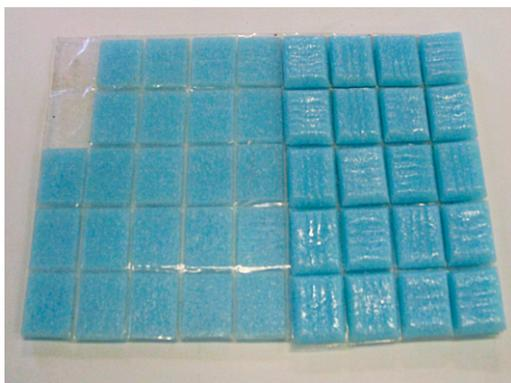
Die einzelnen Mosaiksteine sind hier vorderseitig mit einer durchsichtigen Folie zu einem Blatt zusammengeklebt. Durch die Transparenz und geringe Schichtdicke der Folie lassen sich Fehler beim Einlegen leichter erkennen und die einzelnen Mosaikblätter beim Einlegen leichter positionieren und egalisieren.
