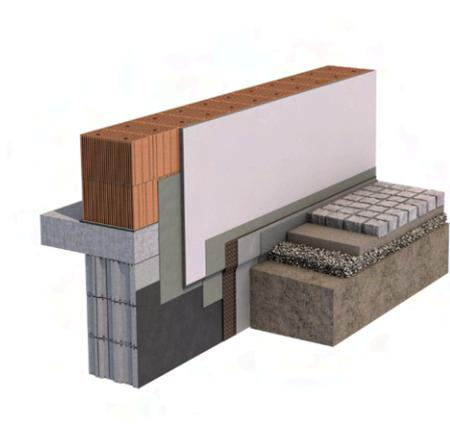
Bild: Systemskizze Sockelabdichtung
