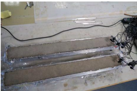
Bild: Schwindrinne mit Messeinrichtung zur Ermittlung von Schwinden und Quellen des Estrichmörtels
