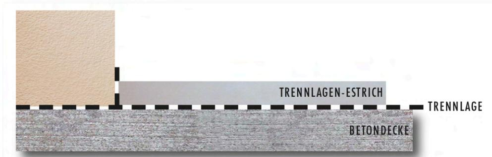
Bild: Aufbau Estrich auf Trennlage
