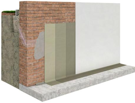
Bild: prinzipieller Aufbau einer Innensanierung
