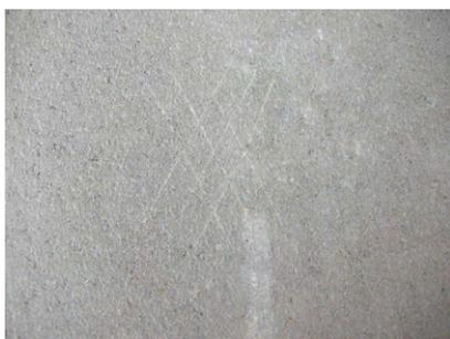
Normale, neue Estrichoberflächen weisen bei dieser Prüfung meist nur linienförmige Strukturen auf, ohne Ausbrüche oder tiefere Ritzspuren. Die Prüfung ist damit bestanden. Die Bewertung des Prüfungsergebnisses erfordert eine gewisse Erfahrung. Bei tiefen Ritzspuren oder erheblichen Ausbrüchen im Kreuzungsbereich sind je nach fachlicher Einschätzung zusätzliche Maßnahmen für die weitere Oberflächenbehandlung erforderlich.
