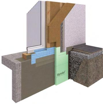
Das Anbinden der Abdichtung ist mit allen genannten Abdichtungsmaterialien möglich, gegebenenfalls unter Zuhilfenahme von Dichtbändern und -ecken.
