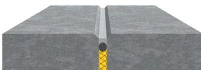
Bild: Systemzeichnung Horizontalfuge befahrbar
