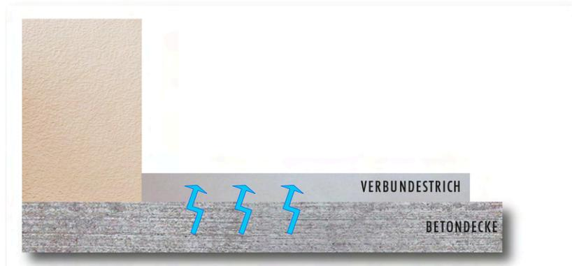
Bild: Feuchtigkeitswanderung aus Betondecke
