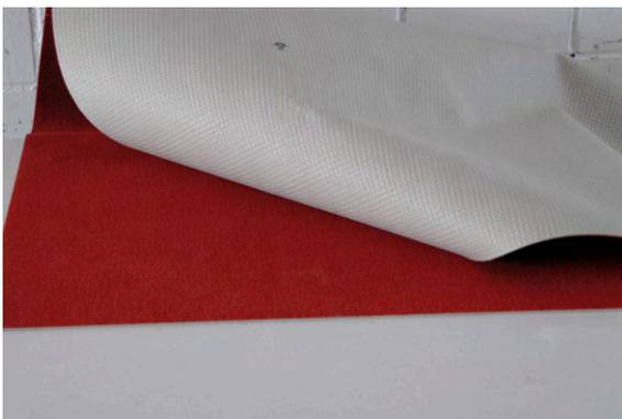
Herstellungsbedingt weisen Flockbeläge, deren Oberseite aus senkrecht in eine Trägerschicht eingesetzten Polfasern besteht, einen PVC-Waffelrücken auf. Zur Klebung des Belages wird daher [THOMSIT K 188 E Spezialkleber Extra](#) mit der Zahnung A2 empfohlen.
