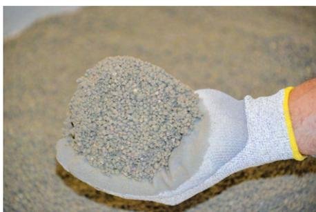
Die Mindestschichtdicke für den fertigen Mörtel beträgt aufgrund seiner festgelegten Kornstruktur nur 5 cm. Je nach Menge des Bindemittels, der eingesetzten Körnung und der Belastung kann die Schichtdicke auch über 10 cm betragen.
