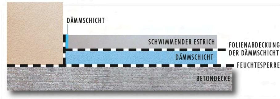
Bild: Aufbau Schwimmender Estrich
