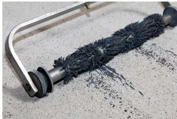
Hier werden mit dem Schleuderrad (Zentrifuge) feste Strahlmittel (Stahlkugeln oder Granulate) aufgeschleudert und mit dem Sauger der Strahlschutt wieder aufgenommen. Im Luftstromabscheider werden Staub und Verunreinigungen vom Strahlmittel getrennt. Auf dem Boden verbleibende Strahlmittel können mit einem Magnetroller wieder gesammelt werden. Für feuchte und nasse Flächen ist diese Methode nicht geeignet.
