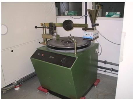
Bild: Verschleißwiderstand nach Böhme
