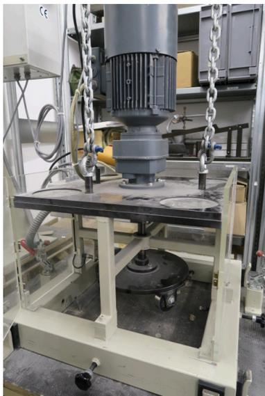
Bild: Verschleißwiderstand nach BCA
