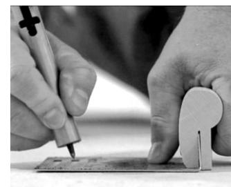
Bewährt hat sich dagegen die „Gitterritzprobe“ mit dem sogenannten Ri-Ri (Richtig-Ritzen) Untergrund-Härteprüfer. Eine Hartmetallspitze kann dabei über eine Metallfeder in drei Positionen eingestellt werden. Bei der Prüfung wird die Metallspitze mit der gewünschten Federbelastung senkrecht an einer speziellen Metallschiene entlanggezogen, sodass mehrere parallel verlaufende Markierungen im Abstand von ca. 10 mm entstehen.
