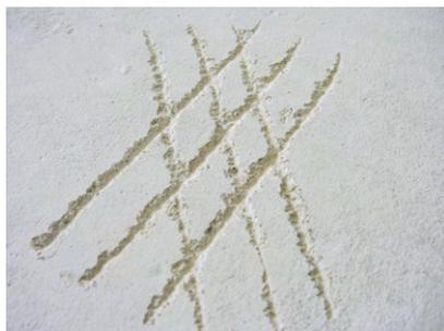
Solche Spuren weisen auf labile Randzonen des Untergrundes hin. Zur Erkennung von harten Schalen/Oberflächenschichten wird die Hammerschlagprüfung eingesetzt, um eventuell darunter liegende weiche Zonen zu erkennen.
