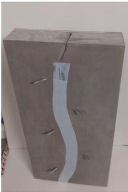
Bild: Injizieren von Epoxidharz zum kraftschlüssigen Verbinden von Betonteilen
