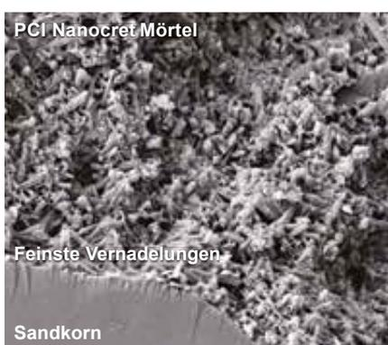
Bild: Struktur von PCI Nanocret
